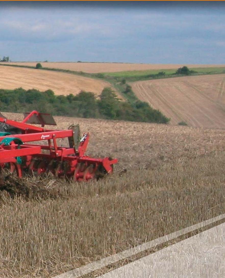
Ausgehend vom Scheibeneggensystem der Kverneland Accord MSC Mulchsaatkombination hat Kverneland eine vordere Scheibensektion entwickelt, mit der Pflanzenrückstände bereits vor den Grubberzinken durchgeschnitten oder eingearbeitet werden.
