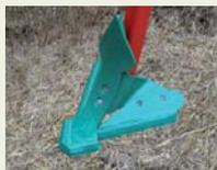
125 mm Doppelherzschar mit Karbidbeschichtung kombiniert mit 360 mm Flügel-scharen mit Karbidbeschichtung.
