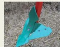
Wechselfares 125 mm Doppelschar kombiniert mit 360 mm Flügel-scharen.
