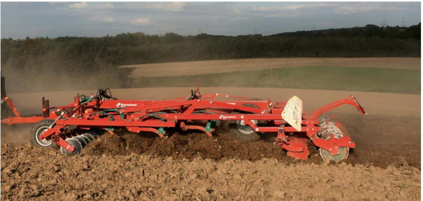
Der CTC kann mit 3 Zinkenreihen und einem Zinkenabstand von entweder 270 mm oder 330 mm ausgestattet werden. Passende Flügelschare gewährleisten eine vollflächige Bearbeitung auch bei sehr flacher GeräteEinstellung. Der große Reihenabstand von bis zu 150 cm und die Rahmenhöhe von 87 cm sorgen für verstopfungsfreies Arbeiten unter allen Bedingungen.
