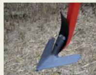
"Quick-Lock" Schnellwechsel-Gänsefußschar in verschiedenen Größen zur flachen Bodenbearbeitung.
